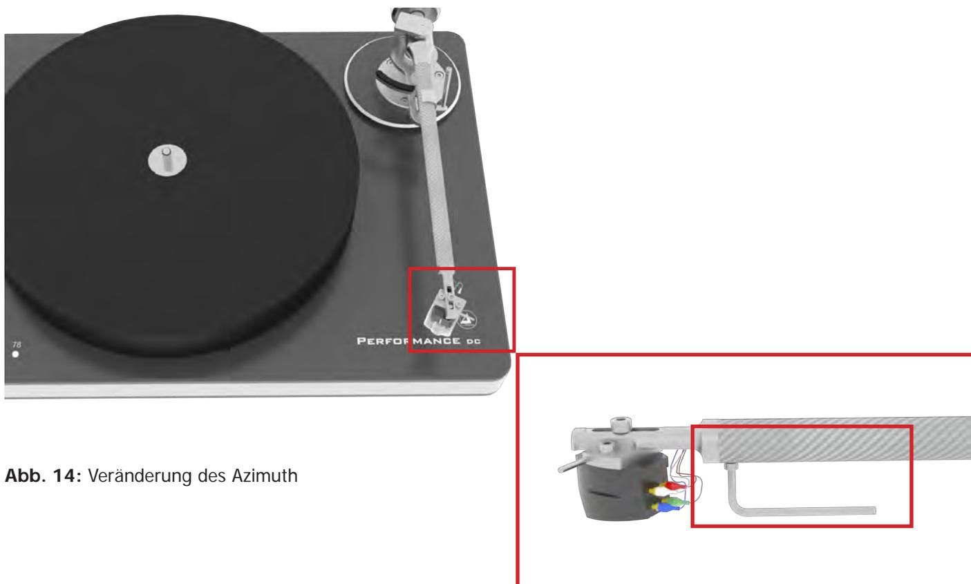
Abb. 14: Veränderung des Azimuth
