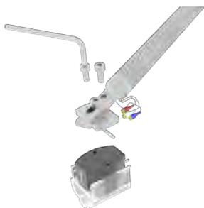
Die nachfolgenden Einstellungen des Tonarmes erfordern die Montage des Tonabnehmersystems auf dem Headshell. Befolgen Sie hierzu die Anweisungen des Tonabnehmer-Herstellers.
