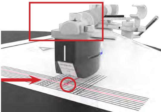
Der Tonabnehmer-Körper muss im Raster der Schablone so ausgerichtet werden, dass die Nadelspitze im Fadenkreuz sitzt und die seitlichen und vorderen Gehäusekanten parallel zu den Rasterlinien (Abb. 11) verlaufen.
