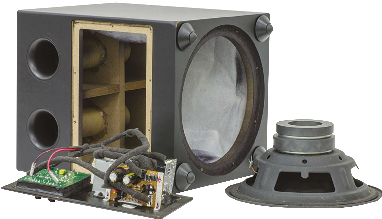
Il subwoofer smontato nei suoi componenti principali. Notiamo la struttura interna del cabinet ben rinforzata, l'elettronica di potenza in classe AB ed il trasduttore col cestello in lamiera ed il doppio anello magnetico.
