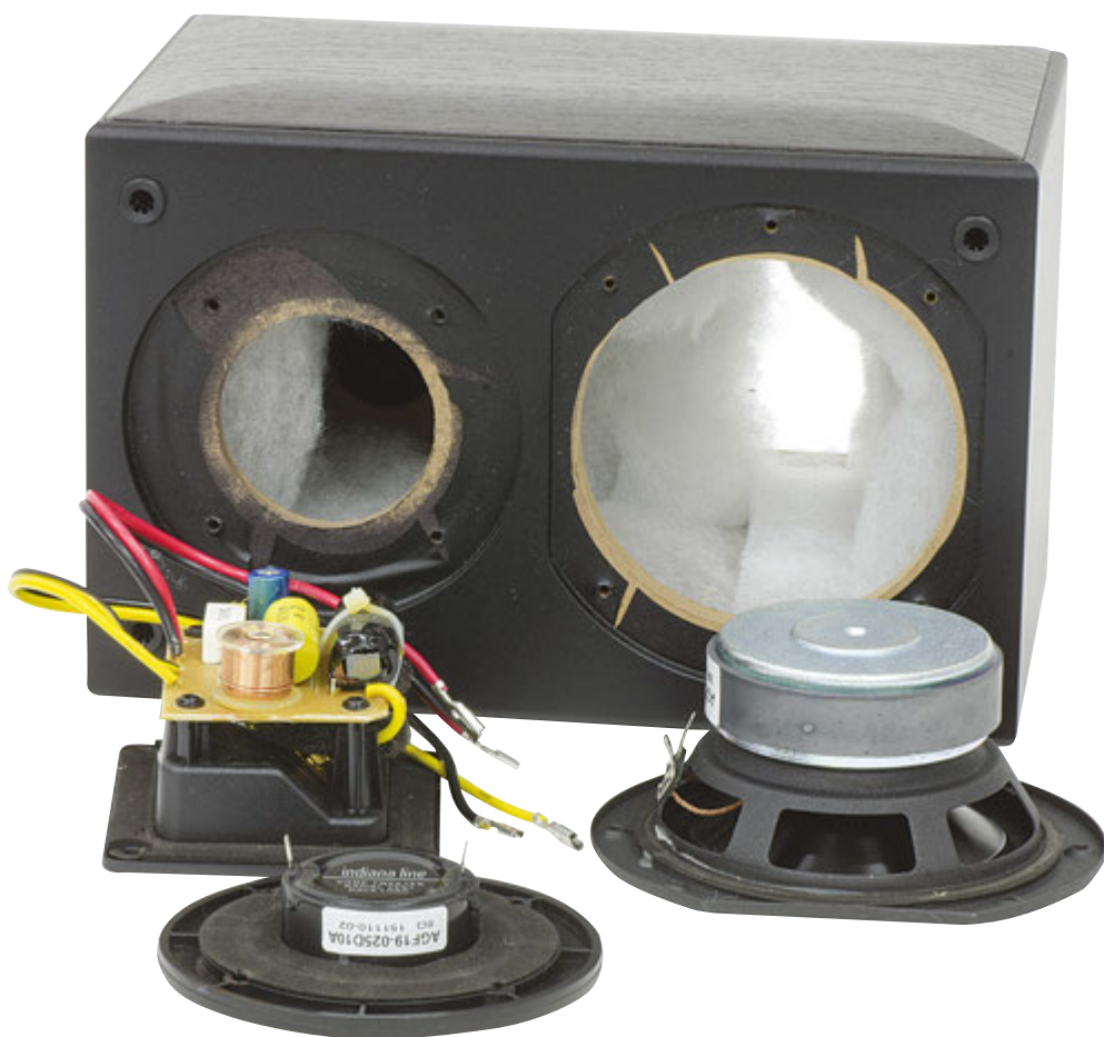
Il satellite. Il filtro crossover è posizionato sul retro della vaschetta portacontatti. Il cabinet è rivestito internamente di materiale acrilico. Il midwoofer ha il cestello in lamiera stampata mentre del tweeter possiamo intravedere la piccola cavità posteriore.
