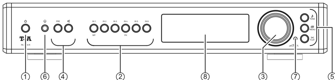
Mit den Tasten an der Gerätefront können alle wichtigen Funktionen des **PA 2000 R** bedient werden. Für die grundlegenden Funktionen wie die Quellenwahl stehen direkte Bedientasten zur Verfügung, seltener benötigte Funktionen werden über Menüs bedient, die über die **MENU** / **TONE** Tasten aufgerufen werden.
