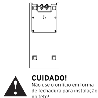
FIGURA 4 INSTALAÇÃO DAS CAIXAS ACÚSTICAS SURROUND EM PAREDE
