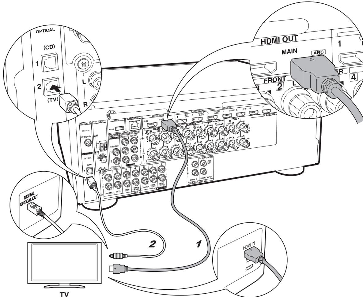
1 HDMI cable, 2 Digital optical cable
