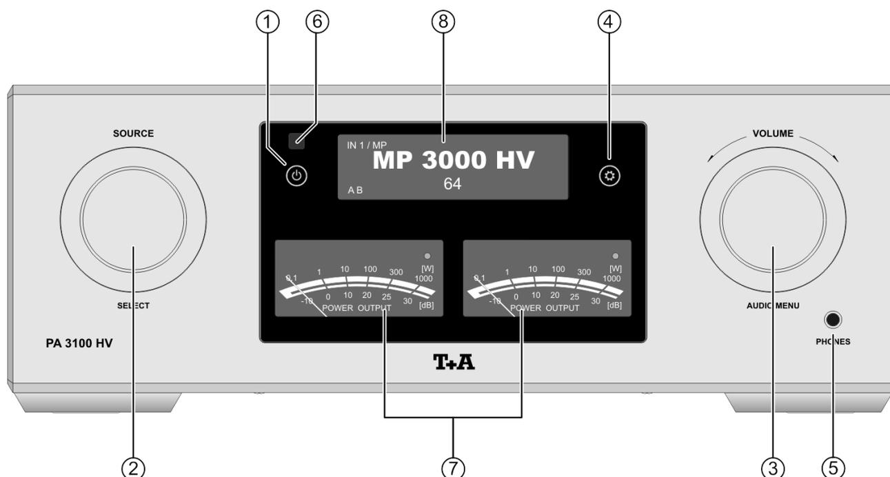
Für die Quellenwahl und Lautstärkeeinstellung stehen die großen Drehknöpfe zur Verfügung. Seltener benötigte Funktionen werden über Menüs bedient, welche über die ⚙️-Taste und den Knopf zur Lautstärkeregelung (VOLUME) aufgerufen werden.
