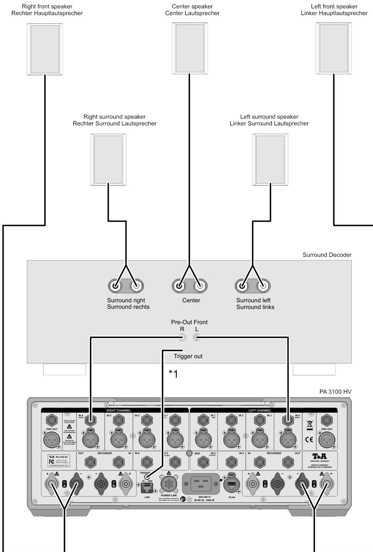
\*1 Triggerleitung optional / trigger connection optional
