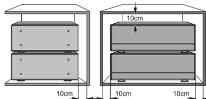
Es dürfen keine wärmeisolierenden Gegenstände (z. B. Decken oder andere Geräte mit ebener Bodenplatte ohne Standfüße) direkt auf das Verstärkergehäuse gestellt werden.
