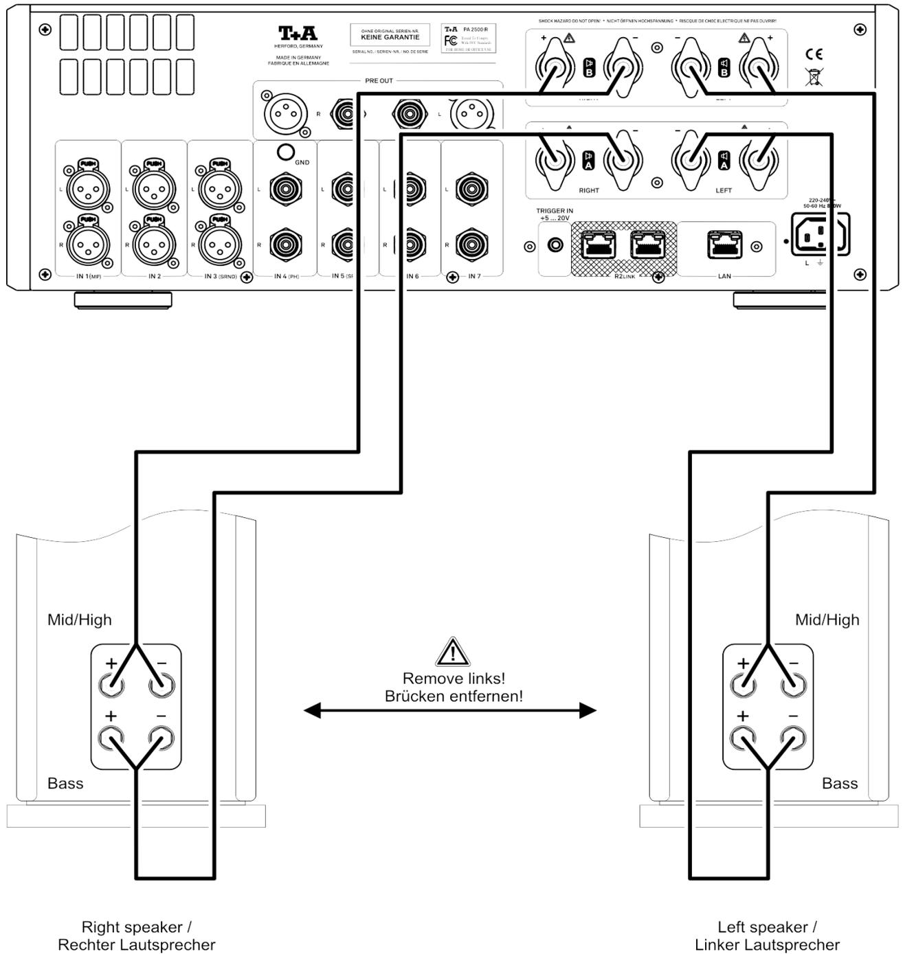
**i** Für den Bi-Wiring Betrieb gibt es einen speziellen Bi-Wiring Modus. Dieser schaltet die Lautsprecherausgänge A und B gleichzeitig über die
