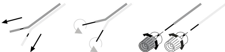
Verificate che nessun filo metta in cortocircuito le uscite degli altoparlanti. Controllate che i morsetti dei diffusori siano ben serrati.
