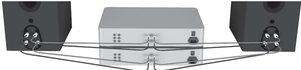
**NOTE:** Необходимо СНЯТЬ перемычки между клеммами.
