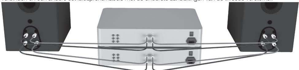
**OPMERKING:** Bij de bedrading van deze methode MOETEN de aansluitingsverbindingen worden verwijderd.
