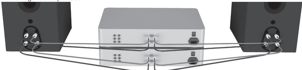
**NOTA:** quando utilizar este método, as ligações dos terminais DEVEM ser removidas.
