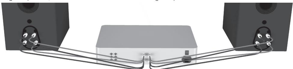
**OPMERKING:** Bij deze methode moeten de aansluitingsverbindingen worden verwijderd.
