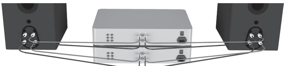
**注意：使用此方式布线时必须除去连接片。**
