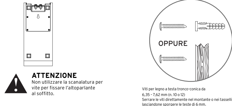
FIGURA 4 FISSAGGIO A PARETE DEGLI ALTOPARLANTI SURROUND
