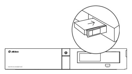
注意:请勿在设备通电的状态下装载或更换硬盘,以免造成设备或硬盘数据损坏,如果是全新硬盘,请先格式化硬盘再装载至设备,本机支持硬盘格式为:EXT3、EXT4、NTFS、FAT32、EXFAT。
