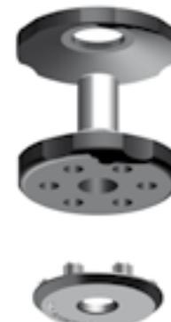
Вы можете удалить полимерные подкладки, если считаете использование одних только шипов более выигрышным вариантом. В этом случае подкладки необходимо удалить до выполнения описанной выше процедуры выравнивания.
