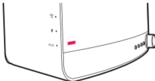
Низкий заряд аккумулятора. Через некоторое время мигание прекращается и индикатор гаснет. Если в этом состоянии нажать кнопку INPUT на передней панели основного аппарата, индикаторы мигают, что свидетельствует о низком заряде аккумулятора.
